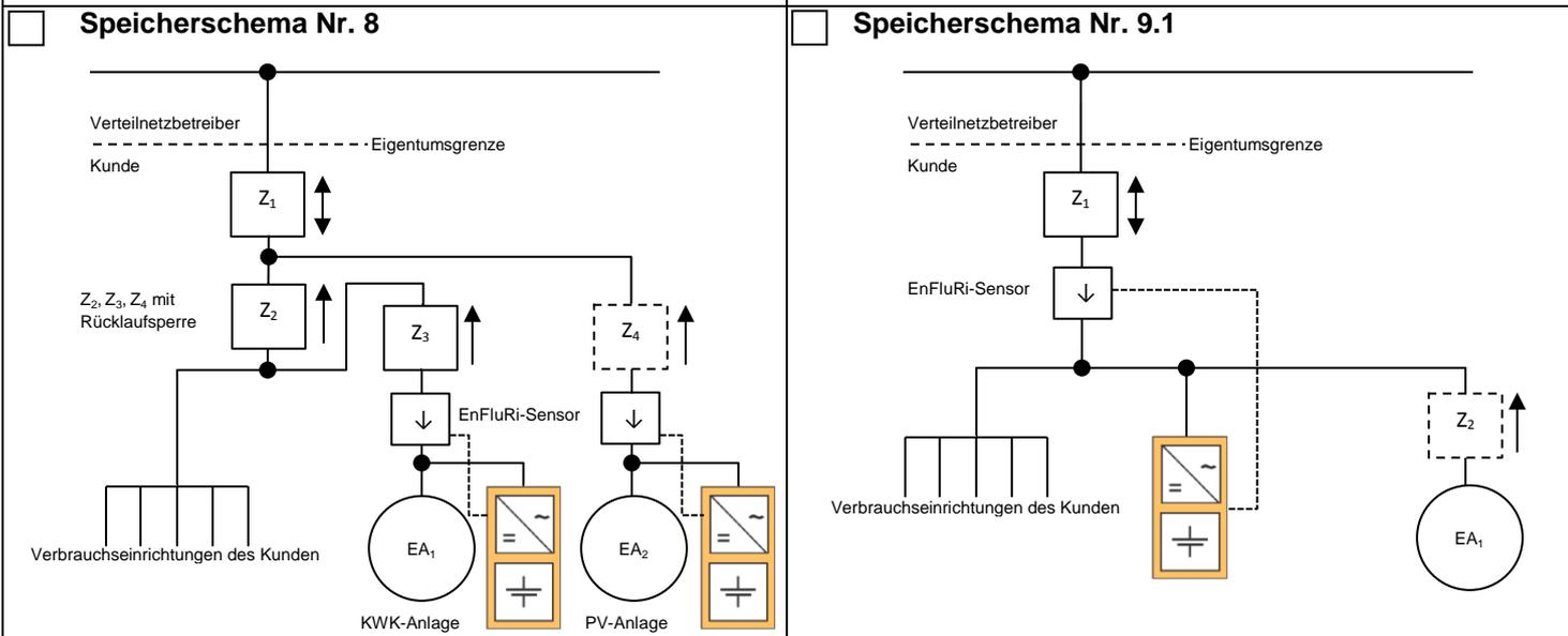
In den vorliegenden Schemabildern sind die Speichersysteme in Kombination mit den gültigen Messkonzepten dargestellt. Die Speicherschemas entsprechen dem Betriebsmodus „Speicher ohne Leistungsbezug aus dem öffentlichen Netz“. Das Speichersystem darf nicht vom öffentlichen Netz geladen werden (Speicherladung aus dem öffentlichen Netz nicht zulässig).
